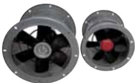
La direzione del flusso è parallela all'asse di rotazione della ventola: l'aria quindi attraversa la girante ricevendo energia da essa e procede in direzione quasi rettilinea, in quanto a causa della rotazione della ventola, al flusso viene trasmesso anche un movimento rotatorio.
