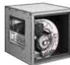
I più comuni montano all'interno gruppi ventilanti centrifughi a coclea, ma ne esistono anche con gruppi centrifughi o a flusso misto senza coclea: in tal caso la cassa verrà conformata internamente per consentire l'indirizzamento del flusso dell'aria ed il recupero di parte dell'energia cinetica in pressione statica.
