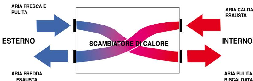
di recuperatori statici sono scambiatori di calore a piastre, batterie accoppiate, scambiatori a tubi...
